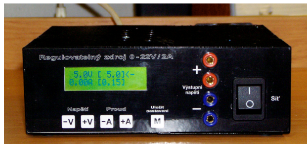
Celkový pohled na zdroj. Rozměry 70x200x200 mm
